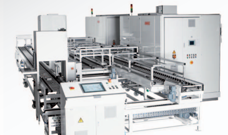
2 Feinstreinigungsanlagen SOLVACS 2 S mit gemeinsamer Verkettungseinrichtung
