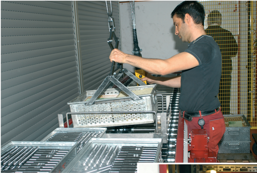
Bild 2: Das Be- und Entladen geschieht manuell über ein Kransystem
