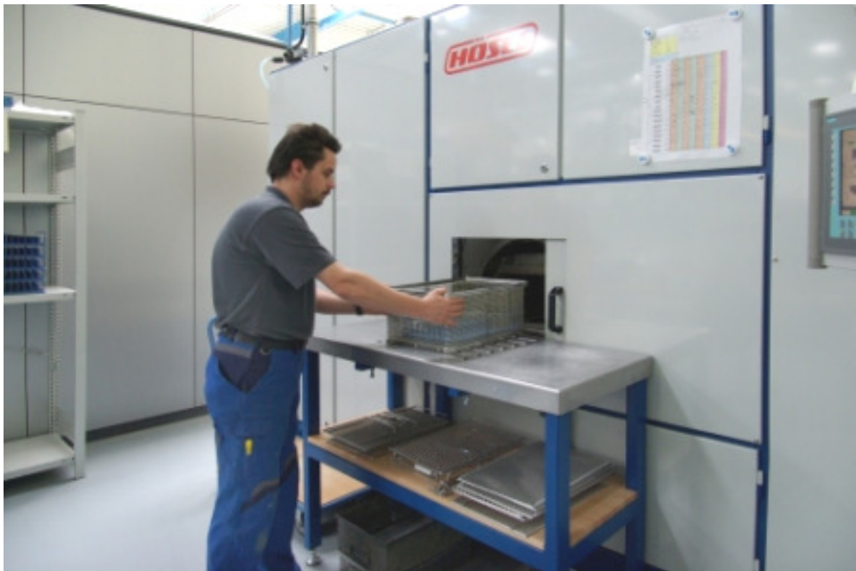
In der Hightech-Reinigungsanlage von Hösel lassen sich wässrige mit lösemittelhaltigen Reinigungsschritten beliebig kombinieren.
