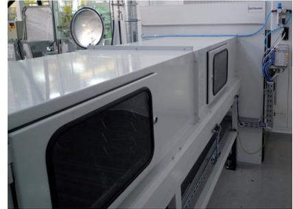
Die gereinigten Teile gelangen über eine Förderstrecke und eine Schleuse in den Sauberraum der Getriebemontage. Bilder: Ralf Högel
