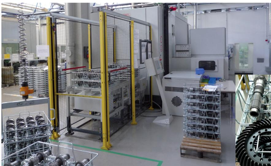
Die kombinierte Teilereinigungsanlage von Hösel ist für die Feinstreinigung von 60.000 Radsätzen im Jahr konzipiert.
